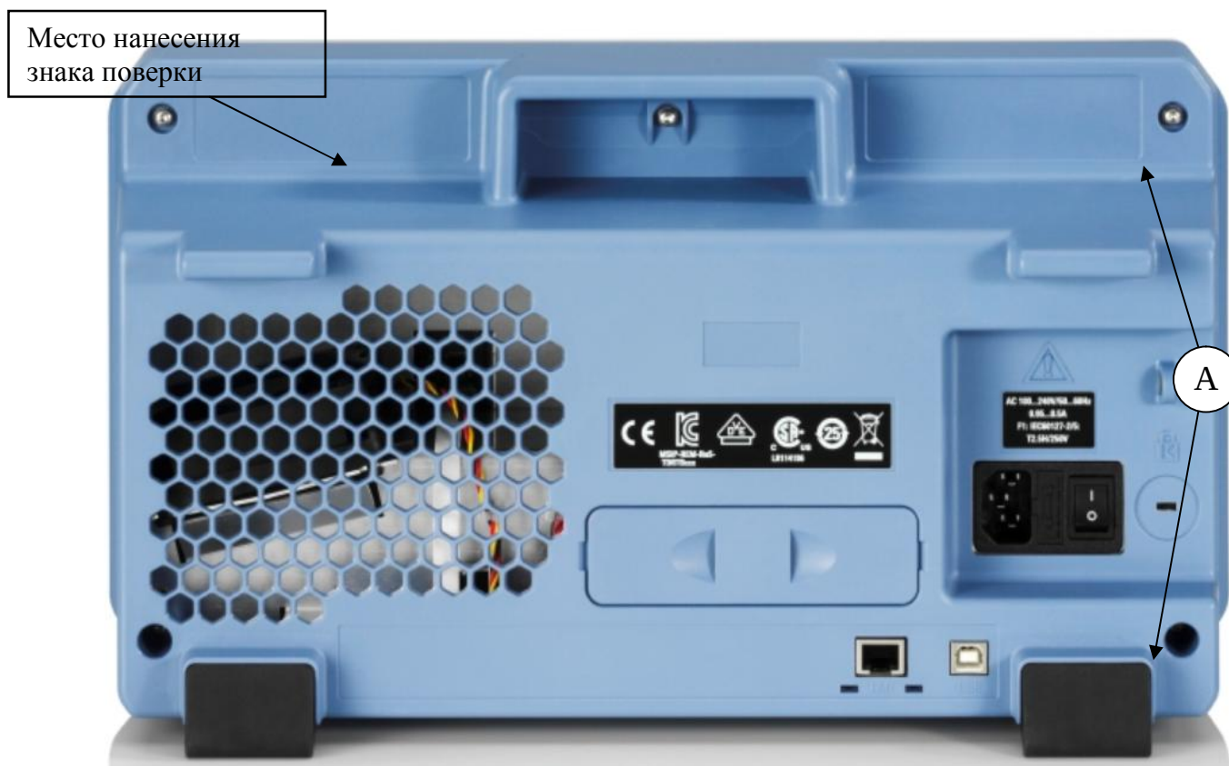
Рисунок 2 - Схема пломбировки от несанкционированного доступа (А) и нанесения знака поверки
